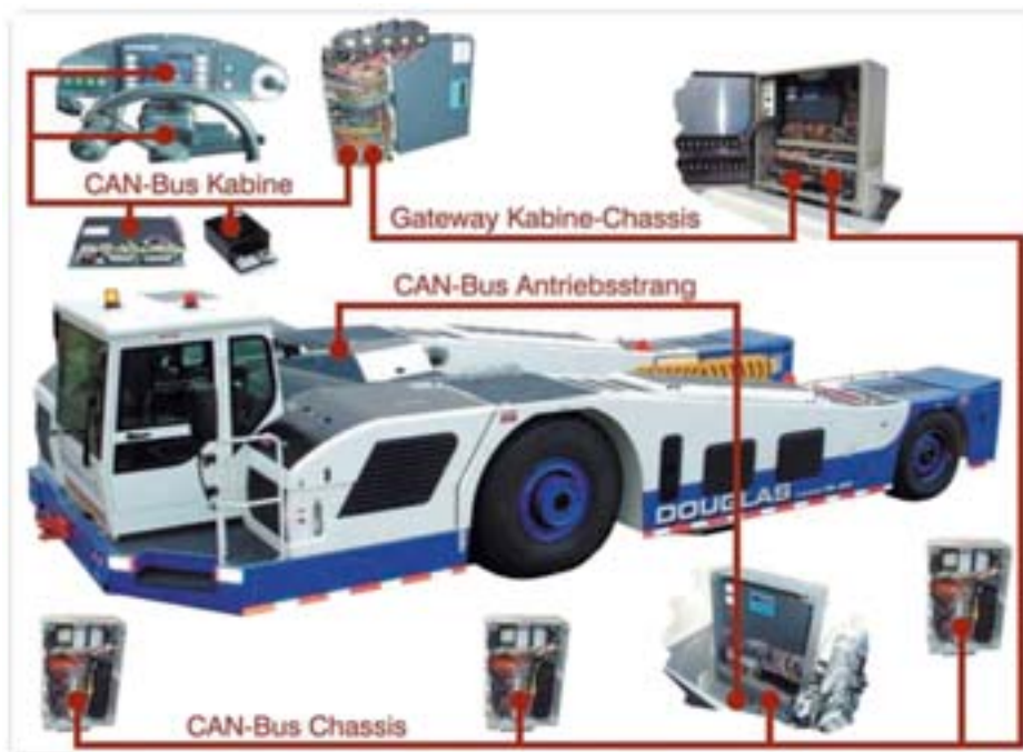
CAN-Bus vernetzte Steuerungssysteme reduzieren Kosten und erhöhen die Zuverlässigkeit des Systems
